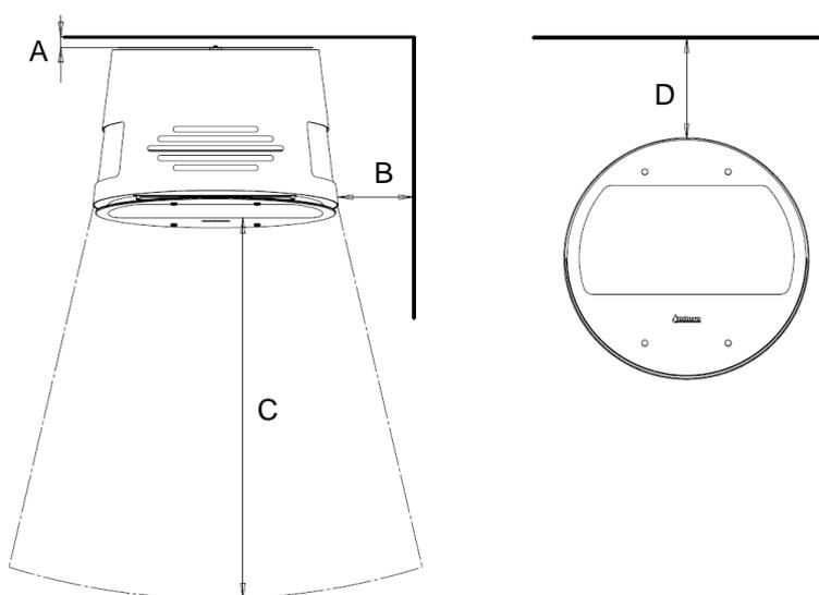
Hvis pejsen vægmonteres, skal den monteres på en ikke-brændbar væg, og placeres den på metalfod, skal den placeres på et ikke-brændbart materiale. Står biopejsen derimod op ad en murstensvæg eller andre ikke-brændbare materialer, er der ingen minimumskrav til afstand.
