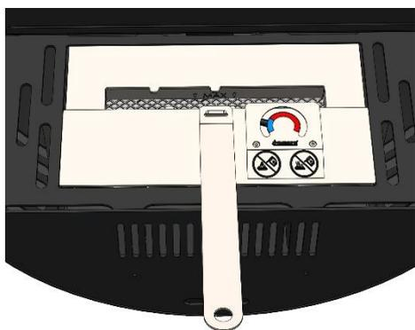
Brug en lang lighter til at tænde pejsen, så dine hænder ikke er direkte over det brændende område. Antænd fibrene i brænderen.
