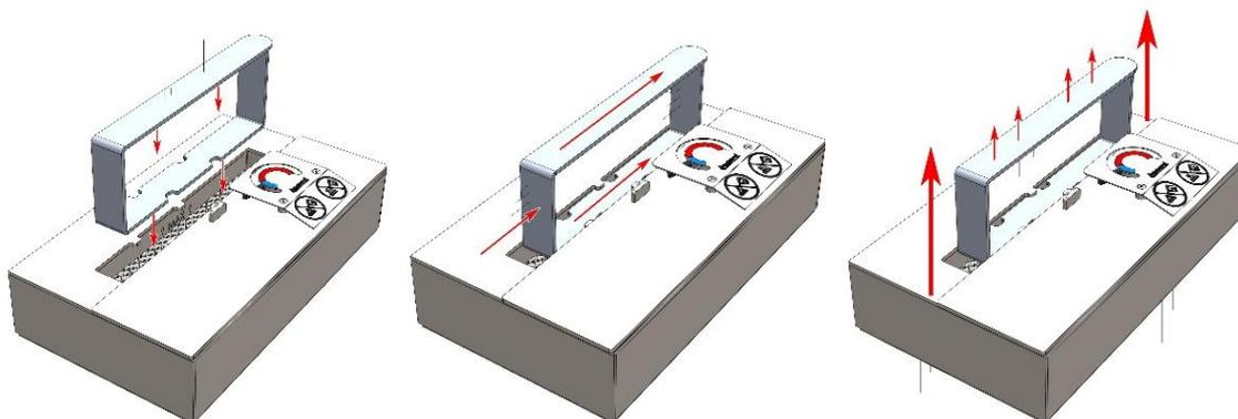
3. Fjern nu slideren med temperaturindikatoren og løft brænderen ud med hænderne.
